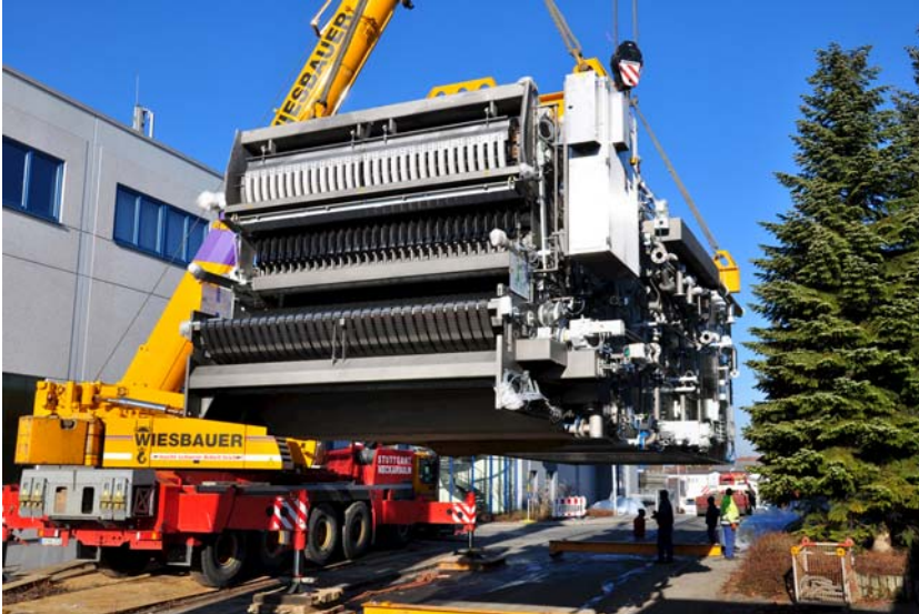
Bildunterschrift: Die im Februar angelieferte neue Flaschenreinigungsmaschine von Romina spart rund 50 Prozent an Wasser und Reinigungsmitteln ein und senkt den Heizölverbrauch um ein Drittel.
